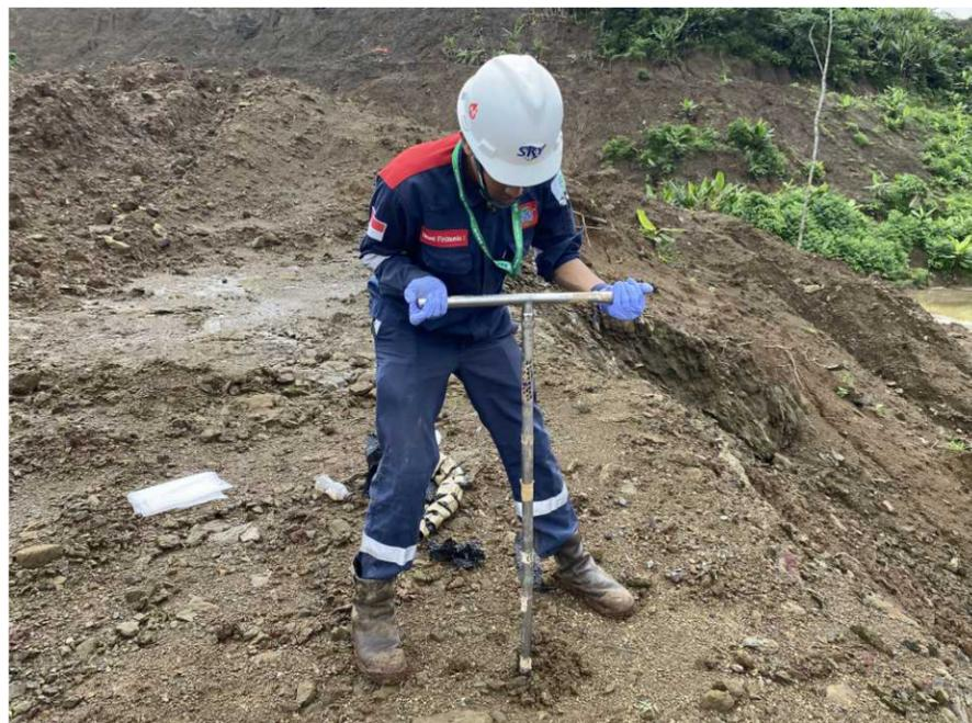
Pengambilan Sampel Permeabilitas Tanah Dasar di Lapangan Tailing
